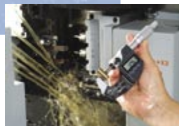
Los materiales resistentes al aceite se usan en todos los componentes de plástico.
