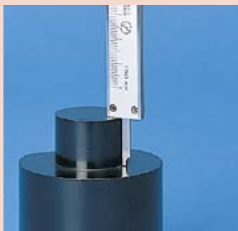
Medición de Profundidad
